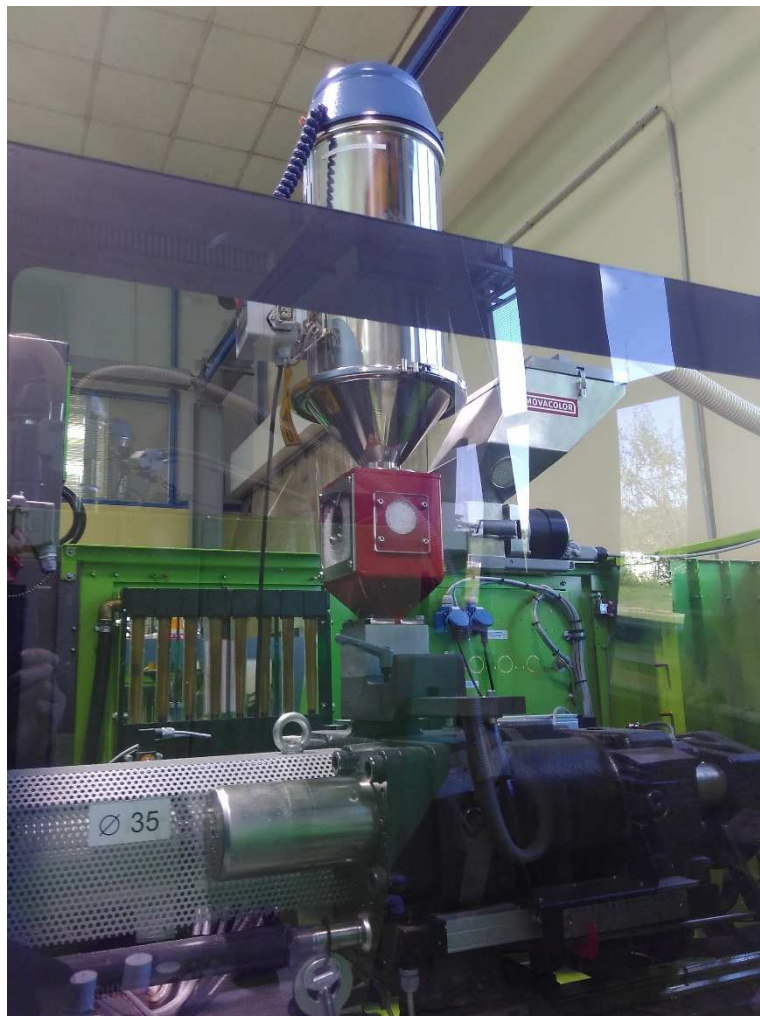
20. kép Dega AS70 felszívó, Movacolor MC18 színezékadagolóval II
